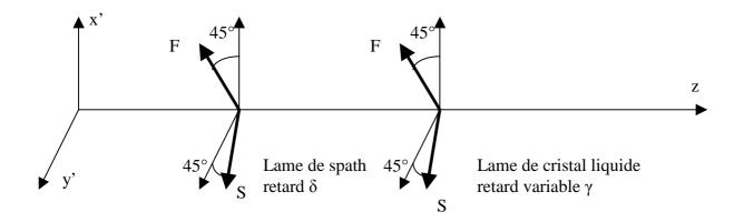
On remplace l'équipage quart d'onde, demi onde rotative, quart d'onde, par une lame à cristal liquide de retard variable  $\gamma$  dont les axes sont parallèles à ceux du spath. Le retard  $\gamma$  peut varier électriquement entre 0 et  $2\pi$ .
