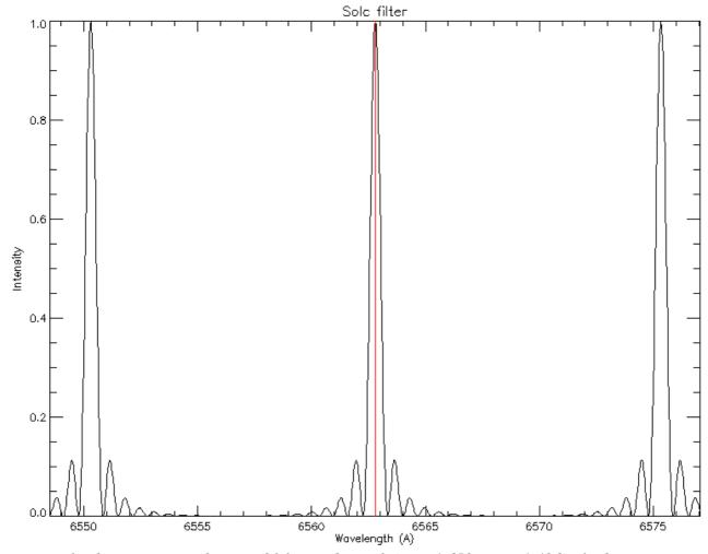
Exemple obtenu avec e = 2 mm et 20 lames de spath ( $n_o = 1.658$ ;  $n_e = 1.486$ ); la distance entre cannelures est de 12 A et la bande passante (largeur à mi hauteur) de 0.5 A.
