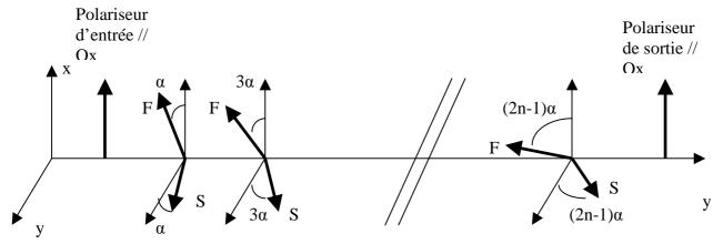
n lames de spath de même épaisseur e, même retard  $\delta$ , d'azimuth en progression arithmétique de raison  $2\alpha$ , soit azimuths respectifs  $\alpha$ ,  $3\alpha$ ,  $5\alpha$ ,  $7\alpha$ , .....(2n-1) $\alpha$
