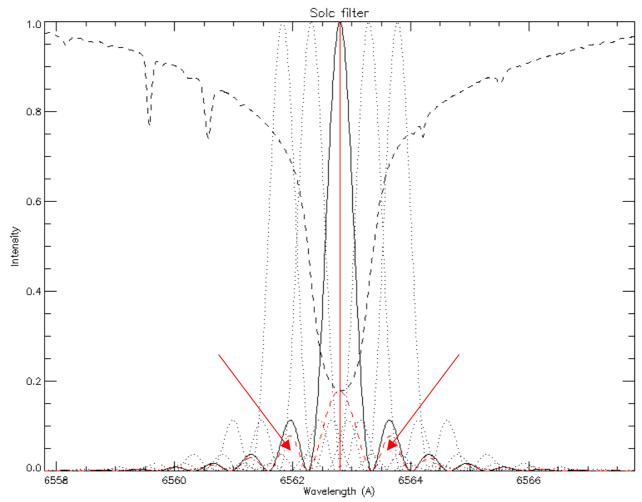
Déplacement de la bande passante par pas de 0.5 A à l'aide d'une lame demi onde rotative par pas de  $\beta = 3.5^{\circ}$ . Epaisseur e = 2 mm, n = 20 étages de spath ( $n_o = 1.658$ ;  $n_e = 1.486$ ). La raie  $H\alpha$  est représentée en tireté (----), ainsi que la raie vue au travers du filtre dans le cas seulement du centrage de la cannelure au centre raie, tireté rouge (----).
