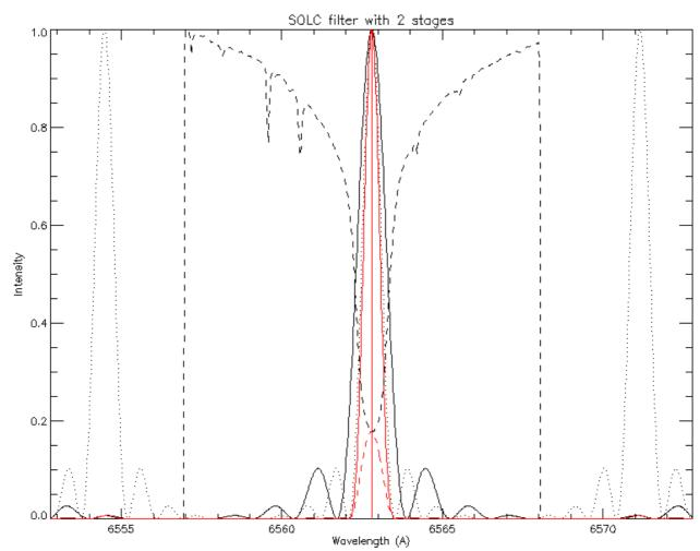
Filtre à 2 étages : 10 lames d'épaisseur e, 10 lames d'épaisseur d = 3 /2 e.
