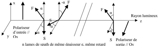
n lames de spath de même épaisseur e, même retard  $\delta$ , d'azimuth <u>alterné</u>  $\alpha$ , -  $\alpha$ ,  $\alpha$ , - $\alpha$ , ....,  $\alpha$ , -  $\alpha$ ,  $\alpha$
